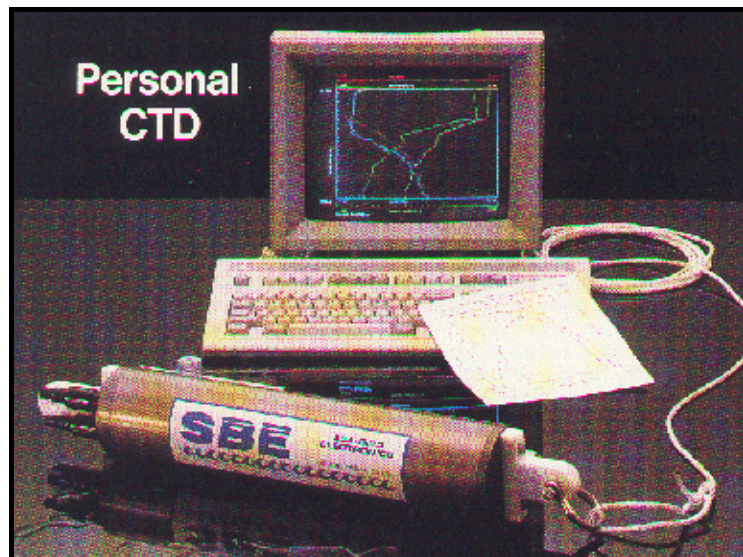
Εικ. 3.5: CTD και σύνδεσή του με ηλεκτρονικό υπολογιστή
